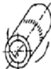
Țeavă: fixă PF Axă: orizontală Sudură: vertical ascendentă
